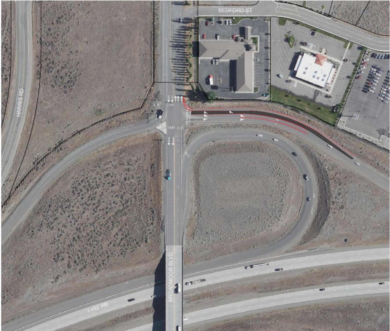
**FIGURE 25: ALTERNATIVE W-S-2 (DUAL RIGHT TURN) CONCEPTUAL LAYOUT**
